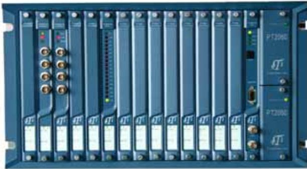
PT2060 系统与以往的派利斯产品相比具有更强大、更全面的现场监测控制功能，是由长期从事振动保护工作的资深工程师经过多年努力研究，采用当今最先进的DSP 微处理器技术实现的一个全数字化的多通道保护表。它可连接各种各样的振动量传感器（加速度、速度、位移、涡流等类型）以及过程量传感器（流量、压力、温度等），对机组或机器提供实时状态监控和保护。PT2060 系统通过数字化的方式与PLC、DCS、计算机等设备交换信息，对机组、机器的运行状态提供全方位的、安全、可靠的保护监测。它具有良好的扩展能力和兼容性，采用EIA 标准箱体，利于现场安装运行和维护。为更好方便用户操作，派利斯公司专门设计PT2060 上位机组态软件。
